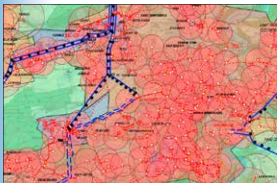
Eine von vielen Auswertungen mit MapEdit: die Analyse der Netzabdeckung durch Trafostationen.
