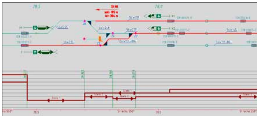
ProSig-Plan mit Streckenausrüstung, Fahrstraßen und Geschwindigkeitsband.
