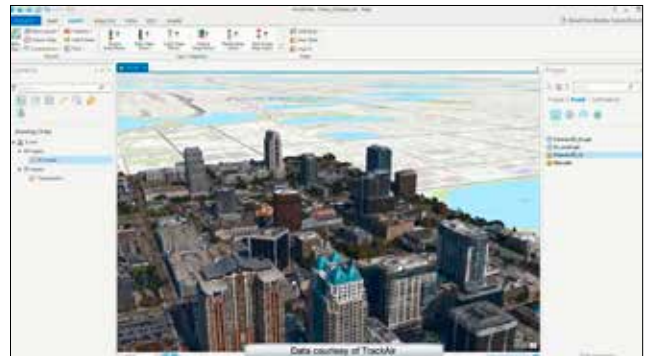
Mit Unterstützung des Formats I3S ermöglicht ContextCapture die Integration von 3D-Realitätsmodellen in ArcGIS-Online-Daten.
